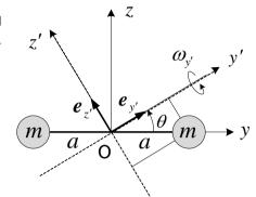
いま、yz面内にあってy軸と $\theta$ の角度をもつy'軸のまわりに、単位の大きさの角速度を与えたとする ( $\pmb{\omega}=1$   $\pmb{e}_{y'}=\{0,\cos\theta,\sin\theta\}$  )。このときの角運動量ベクトルは、xyz座標系において、
