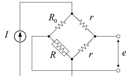
定電流法は、通電する電流  $I$  を一定とする方法であるが、抵抗  $R$  が温度  $T_w$  によって変わるので、投入熱量
